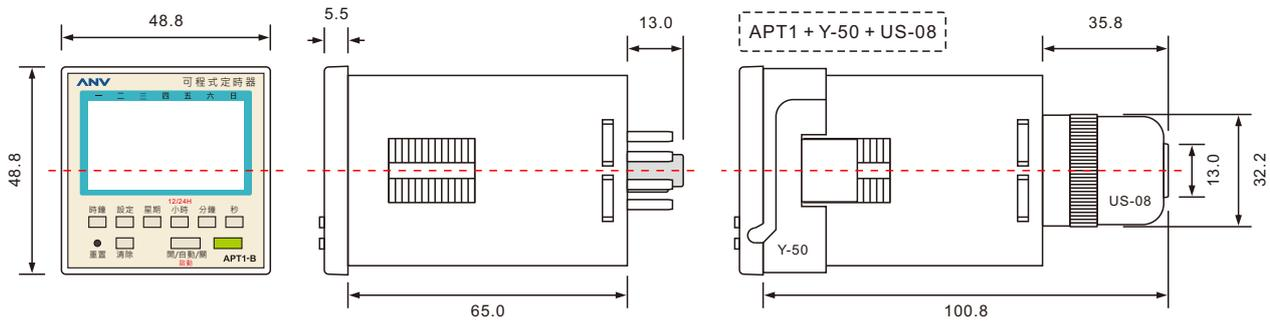
露出型：使用N-3TB轉換端子；埋入型：使用Y-72支架
